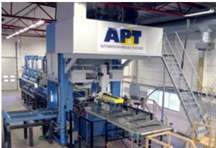
Från plåtämne till B-stolpe. Presslinjen som Baosteel köpt av AP&T kommer att användas för att utveckla framtida produktionslösningar för fordonskomponenter.
